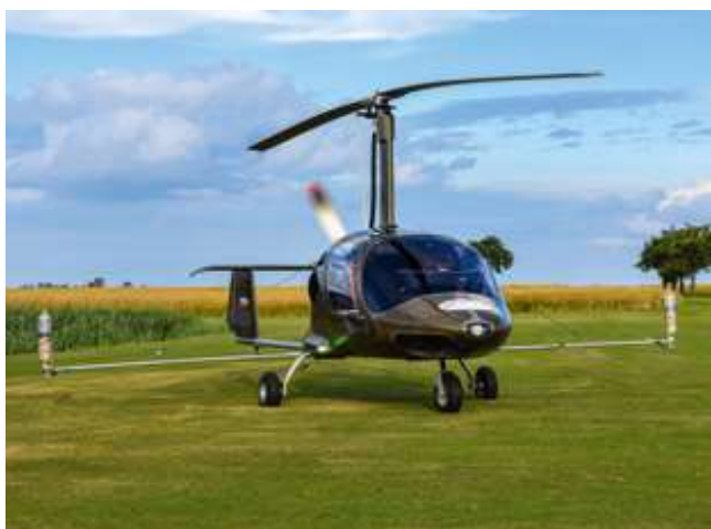
Wiatrakowiec z aparaturą do aplikacji preparatu TrichoLet
