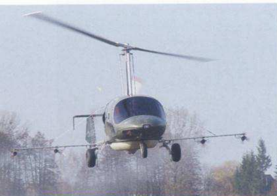
Wiatrakowiec ZEN 1 produkcji firmy Artur Trendak&Son z Kolonii Jaktorów (adaptacja do zabiegów agrolotniczych firma AirAgro) w wersji do ultraniskociężnościowego oprysku (ULV - ultra low volume).
